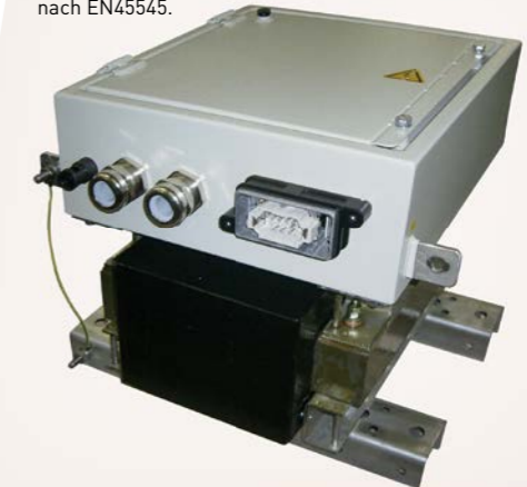
Bahntrafo 10kVA , vergossene Ausführung für Außenmontage. Angebauter Schrank mit Einbauten für Temperaturüberwachung. Einhaltung der Brandschutzanforderungen nach EN45545.
